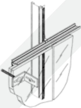
Il sistema di supporto del rivestimento esterno è realizzato mediante l'inserimento della lastra nel profilo orizzontale e il bloccaggio della stessa, nella parte alta, mediante le molle inserite a scatto nel profilo orizzontale.
